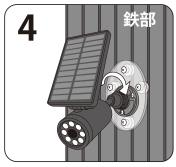
本体の角度調整をしながら締め込みリングを時計回りに締めて固定します。
