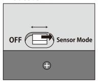
点灯させるにはソーラーパネル 裏面にあるスイッチをセンサー モード (Sensor Mode) にしてく ださい。
