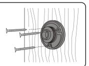
コンクリートに設置される時は 直径6mm深さ30mmの下穴を 開け、付属の樹脂製プラグを打 ち込んでから木ネジでベースを 取り付けてください。
